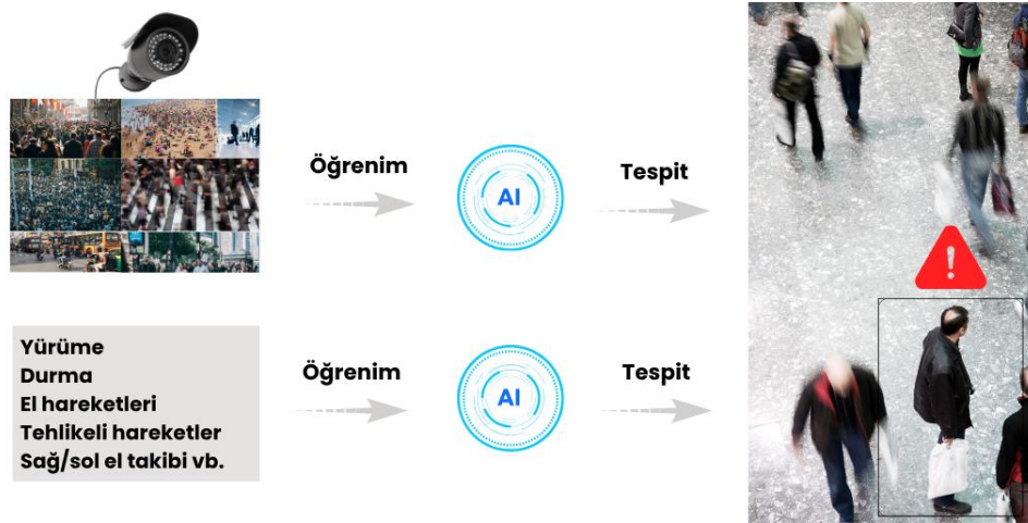
Şekil 3. 4. Tehlikeli ya da Şüpheli Hareket Algılama Sisteminin Detayları
