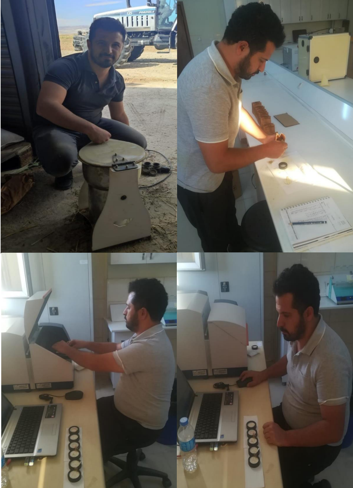
Şekil 3.6. Kuru Ot Numunesi Öğütme ve NIR Cihazında Teknolojik Analiz Ölçme İşlemleri.
