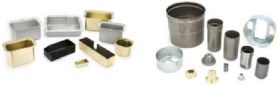
Şekil 2.17. Derin çekme yöntemi ile üretilmiş örnek parçalar (Yıldız, 2017).
