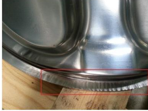
Şekil 2.9. Çamaşır makinesine ait bir sacda meydana gelen kırışıklık (Doğu, 2014).
