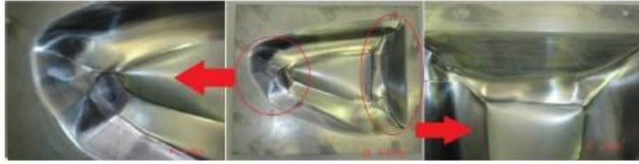
Şekil 2.13. Otomobile ait çamurluk sacının üretiminde karşılaşılan şekil bozukluğu sonrası elde edilen ürün (Durgun vd., 2016).
