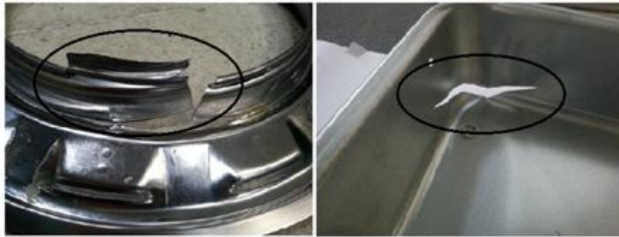
Şekil 2.8. Şekillendirme sonrası sac metalde meydana gelen yırtılma örneği (Doğu, 2014).
