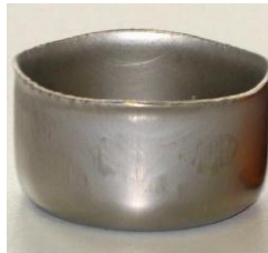
Şekil 2.10. Derin çekme sonrası paslanmaz çelikte meydana gelen kulaklanma (Doğan, 2015).
