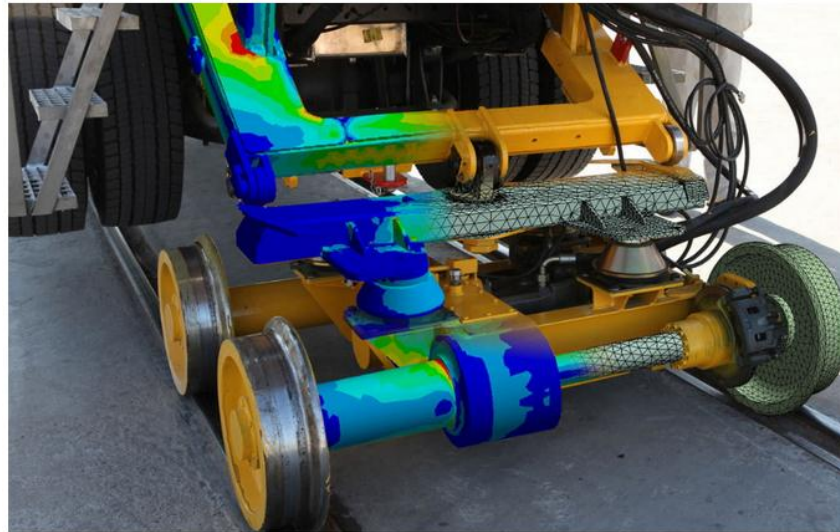
Şekil 3.3. Otomotiv parçalarına uygulanan sonlu elemanlar analizi (Sonlu Elemanlar Analizi, 2019).
