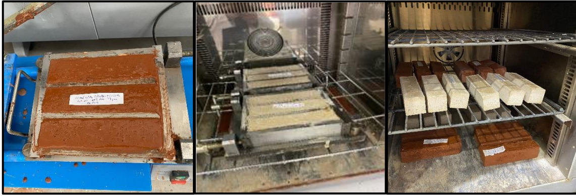
Şekil 4. Üretilen jeopolimer harçlar ve etüvde kür işlemleri.
