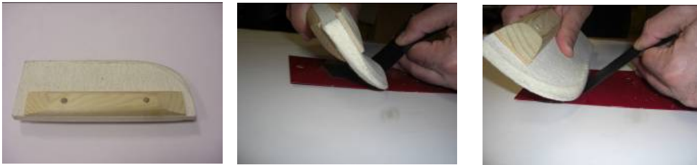
Şekil 4.10. Kaplama sonrası yapışma bandı uygulama yöntemi
