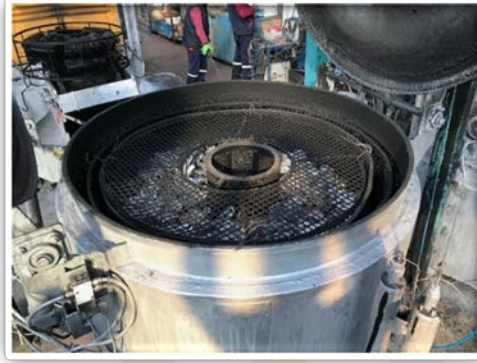
Şekil 4.3. Parçanın kaplanması ve sonrasındaki santrifüj işlemi
