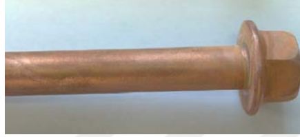
Şekil 4.6. Hogaboom testinden başarılı olan parça
