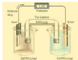
Şekil 2.1. Elektrokimyasal hücrenin şematik gösterimi
