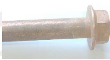
Şekil 4.7. Hogaboom testinden başarısız olan parça
