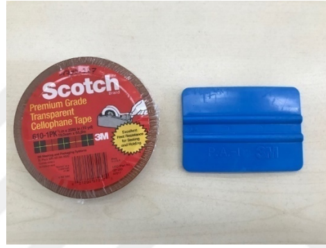
Şekil 4.9. Kumlama sonrası yapışma test kiti
