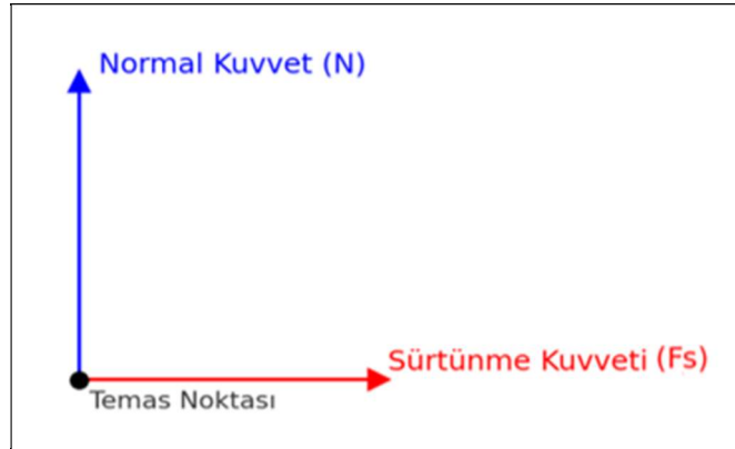
Şekil 2.1. İki yüzeyin temasında oluşan sürtünme kuvveti ve normal kuvvet (Hibbeler, 2016; Meriam, 2012).
