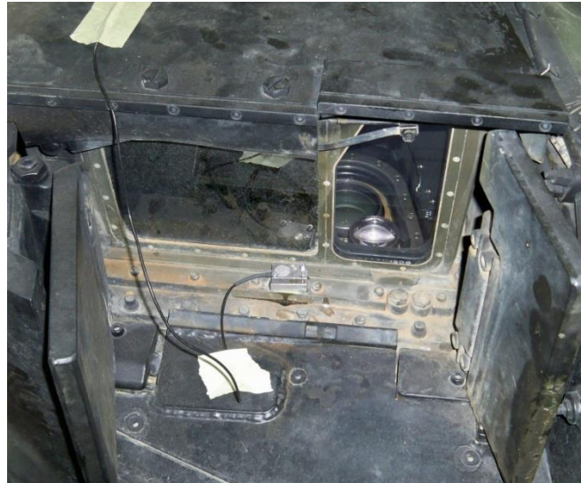
Şekil 3.7. 1 adet üç eksenli ivmeölçer araç tavanı üzerinde
