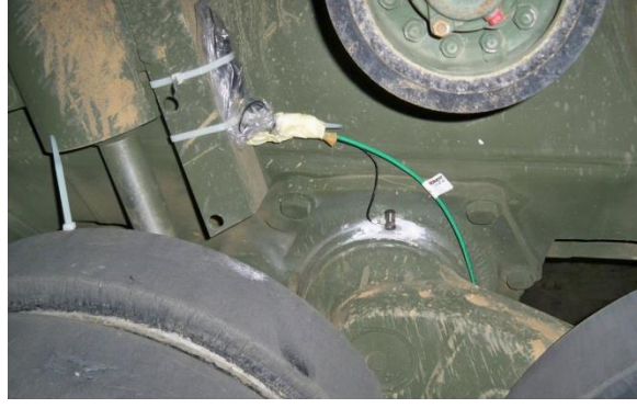
Şekil 3.8. 1 adet tek eksenli ivmeölçer sağ taraftaki üçüncü askı koluna
