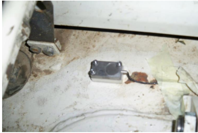
Şekil 3.6. 1 adet üç eksenli ivmeölçer şoförün yanında, gövde zemini üzerinde
