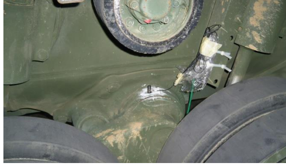
Şekil 3.9. 1 adet tek eksenli ivmeölçer sol taraftaki üçüncü askı koluna
