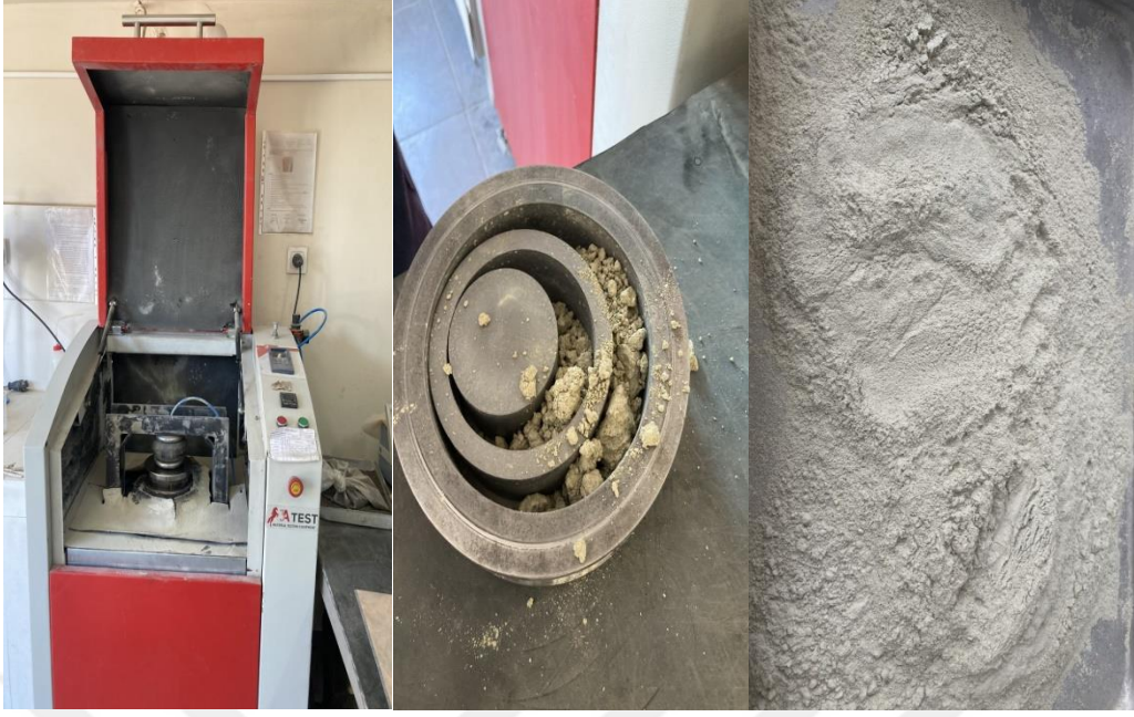
Şekil 3. 3. Halkalı Öğütücüde Kırılmış 250 Mikron Altı Kil
