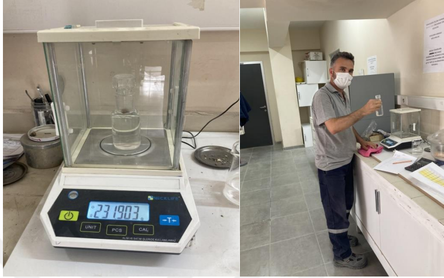
Şekil 3. 8. Piknometre Kullanarak, Arşimet Prensibi İle Tane Yoğunluğu Tespiti
