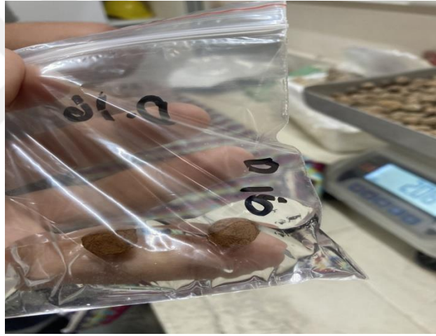
Şekil 3. 9. 24 Saat Suda Bekletilen Genleştirilmiş Kil Numunesi
