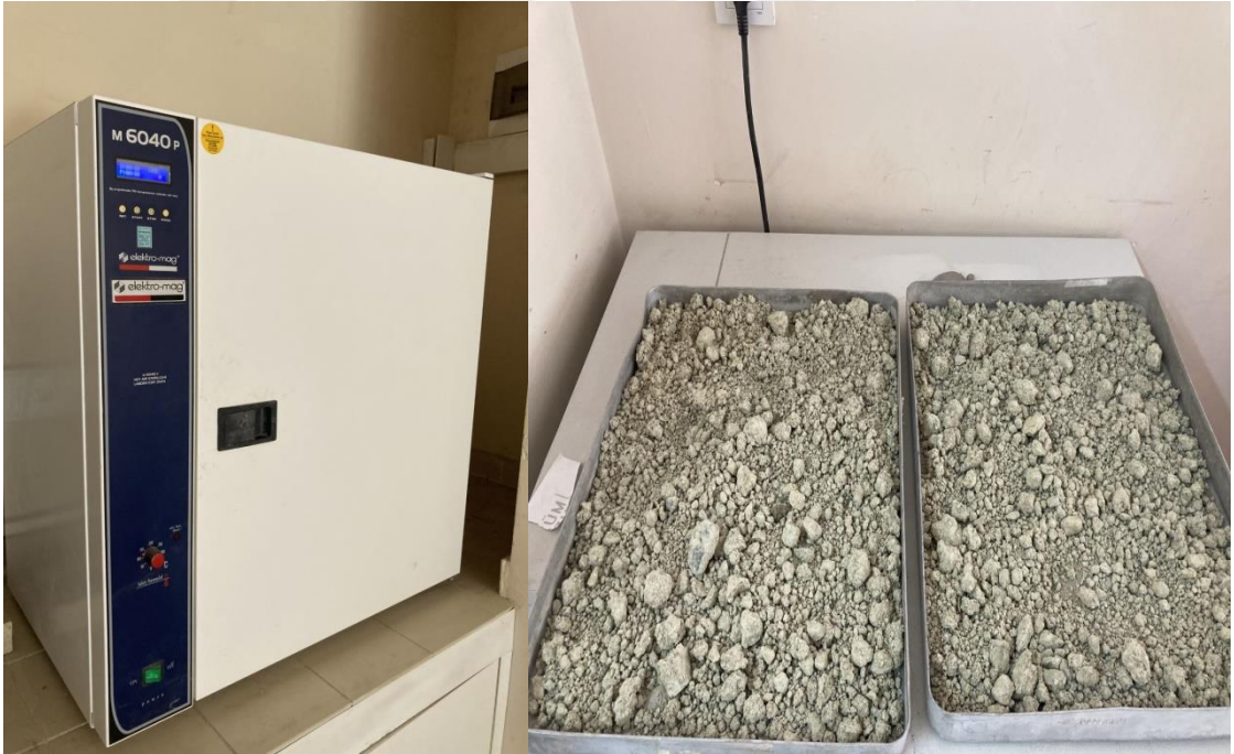
Şekil 3. 2. Etüvde Kurutulmuş Kil Numuneleri
