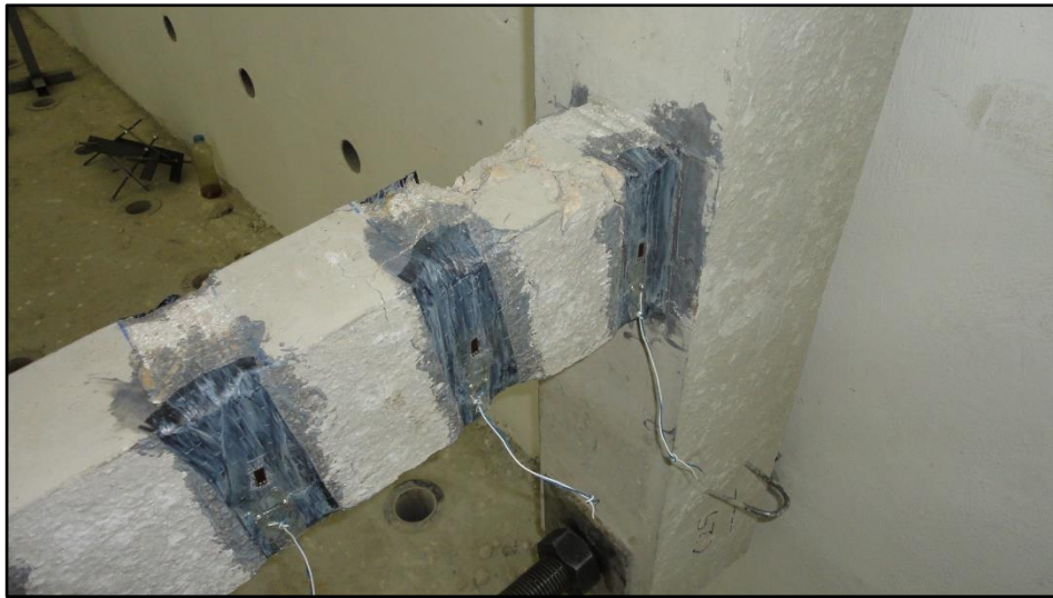
Şekil 4.35. S3 deney elemanına yapıştırılan strain gauge'ler.
