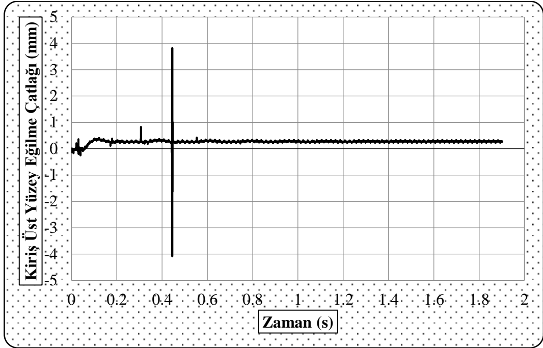
Şekil 4.9. S1 deney elemanına ait kiriş üst yüzeyi eğilme çatlakları-zaman grafiği.
