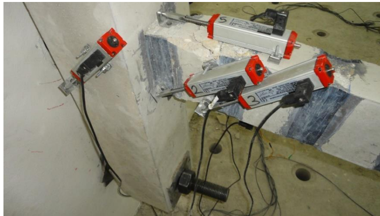
Şekil 4.29. S3 deney elemanına ait potansiyometrik cetvel örneği.
