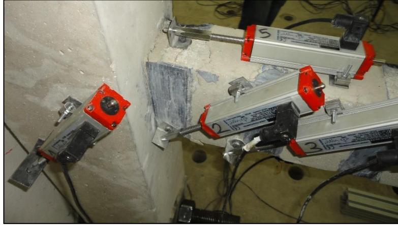
Şekil 4.54. S5 deney elemanına ait potansiyometrik cetvel örneği.
