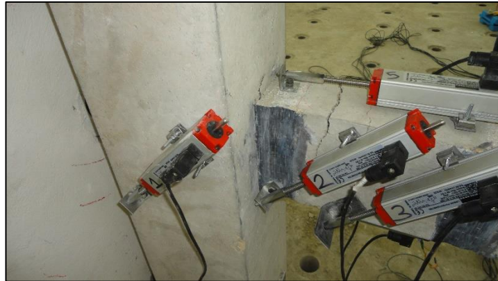
Şekil 4.43. S3 deney elemanına ait potansiyometrik cetvel örneği.
