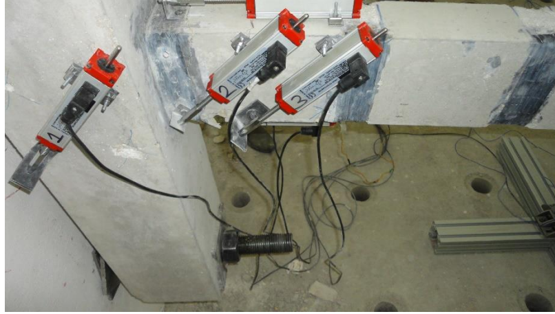
Şekil 4.67. S6 deney elemanına ait potansiyometrik cetvel örneği.
