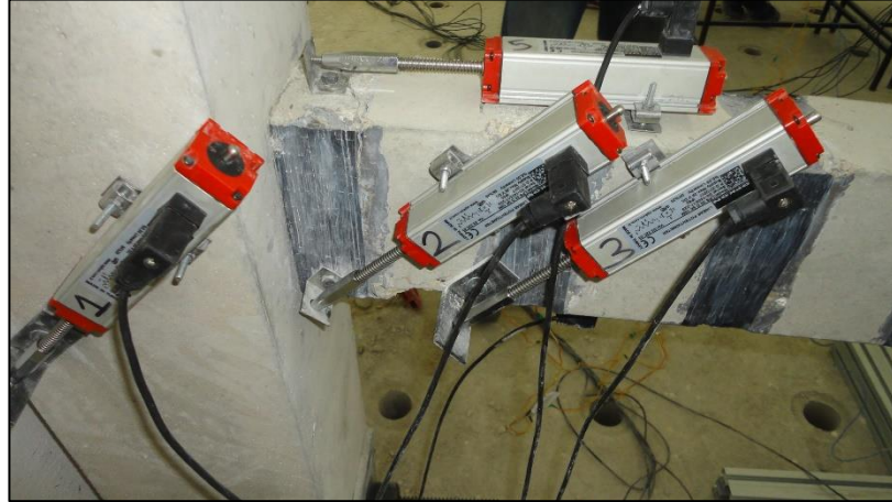
Şekil 4.78. S7 deney elemanına ait potansiyometrik cetvel örneği.
