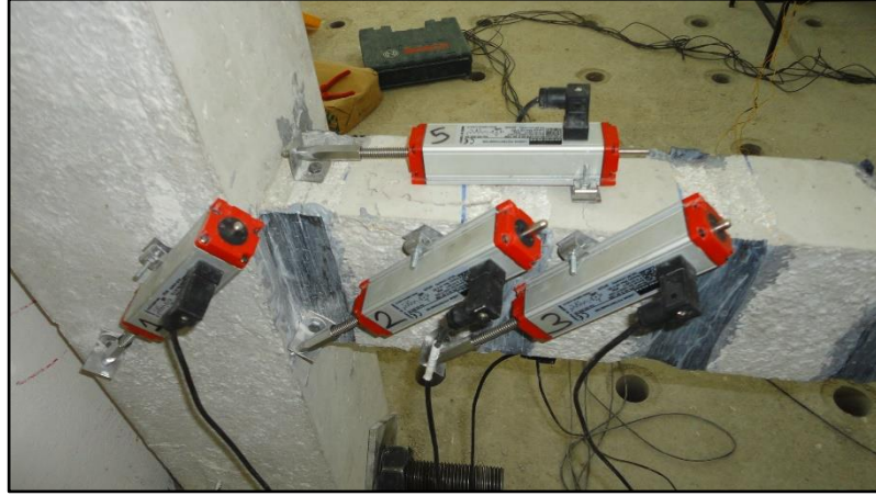
Şekil 4.5. S1 deney elemanına ait potansiyometrik cetveller.
