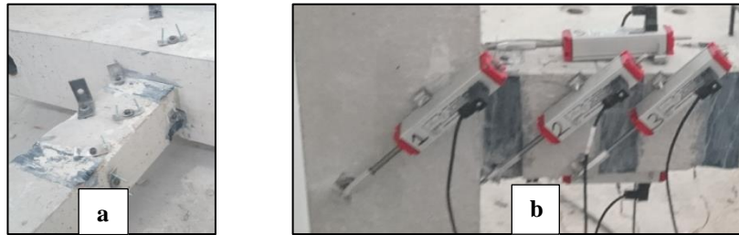
Şekil 3.15. Metal kanca ve potansiyometrik cetvellerin numuneye uygulanması.
