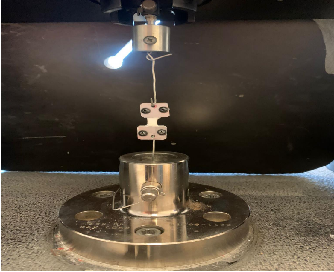
Şekil 2.1. Örneklerin çekme test cihazına yerleştirildikten sonraki görüntüsü.
