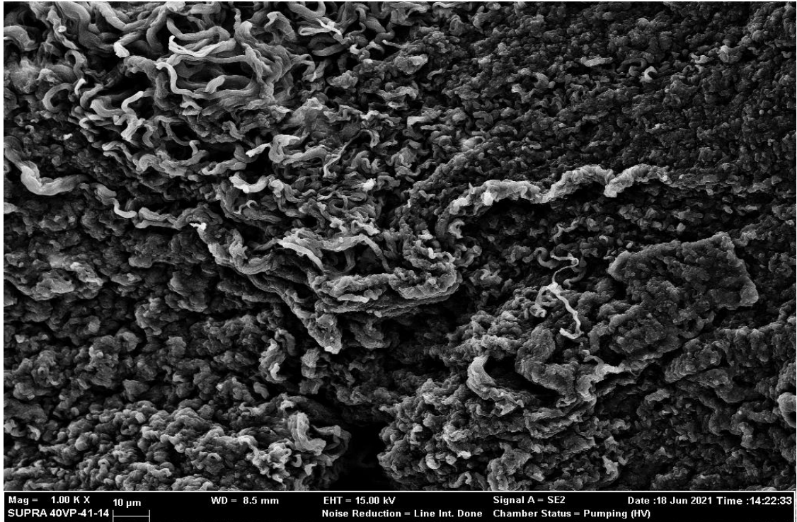
Şekil 3.4. Hüresizleştirilmiş yaprakçık örneğinin SEM mikrografi (1000X yakınlaştırma).
