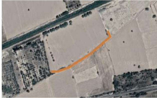
Şekil 4.2. Uzman tarafından belirlenen yeni GES tasarımında yapılması muhtemel olan ve santral kenarına paralel 5m yüksekliğe konulan yansıtma kesici ışık geçirmeyen (opak) bariyer
