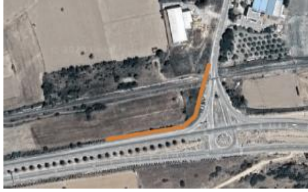
Şekil 4.1. Uzman tarafından belirlenen yeni GES tasarımında yapılması muhtemel olan yol kenarına paralel 3m yüksekliğe konulan yansıtma kesici ışık geçirmeyen (opak) bariyer
