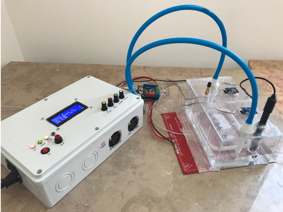
Şekil 3.5. Daldırma deneyi için kullanılan deney düzeneği.
