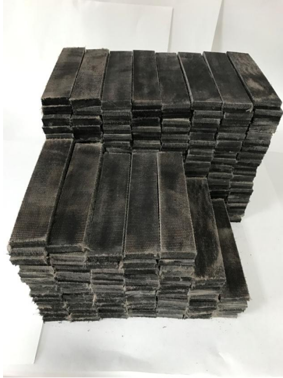
Şekil 7.7. Kesilen ve taşlanan konveyör bant numuneleri.
