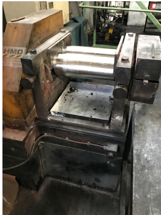
Şekil 7.2. Kauçuk hamurlarının hazırlanmasında kullanılan laboratuvar tipi iki silindirli açık mil.
