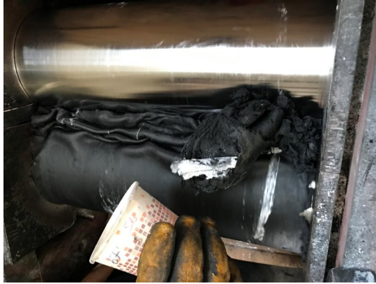
Şekil 7.5. Kloropren kauçuk hamuruna metal oksit ve hızlandırıcıların eklenmesi.
