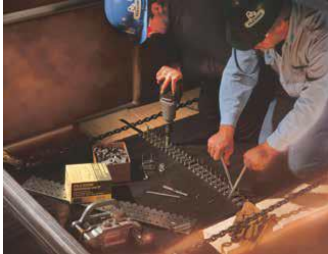
Şekil 2.7. Konveyör bantların mekanik ekler ile birleştirilmesi (Flexco, 2015).
