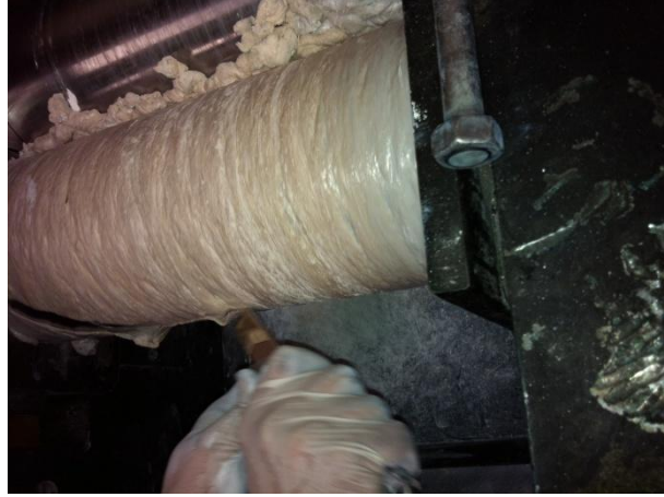
Şekil 7.3. Kloropren kauçuğun homojen kıvamlı hamur haline getirilmesi.
