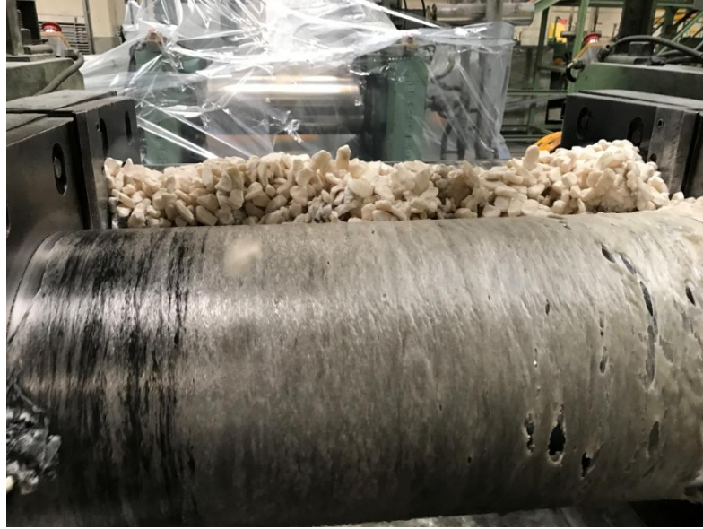
Şekil 7.19. Kloropren kauçuğun homojen hamur haline getirilmesi.
