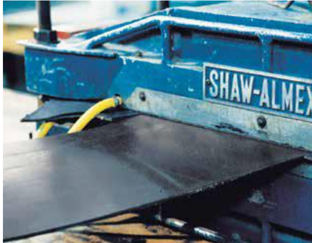
Şekil 2.5. Konveyör bantların pres kullanılarak sıcak vulkanizasyon ile eklenmesi (Flexco, 2015).
