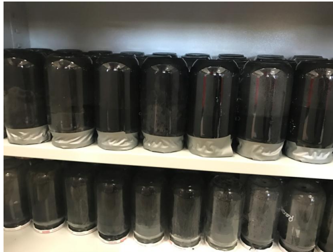
Şekil 7.6. Depolanan soğuk vulkanize yapıştırıcı sementleri.
