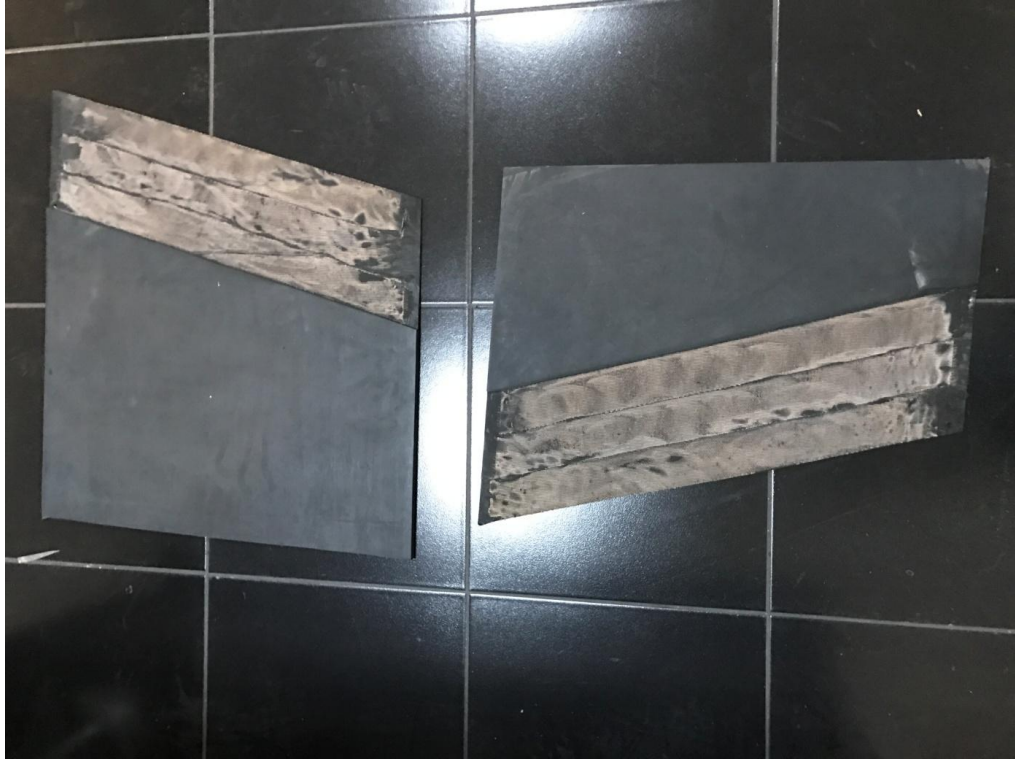
Şekil 7.24. Katları ayrılmış ve taşlanmış konveyör bant numuneleri.
