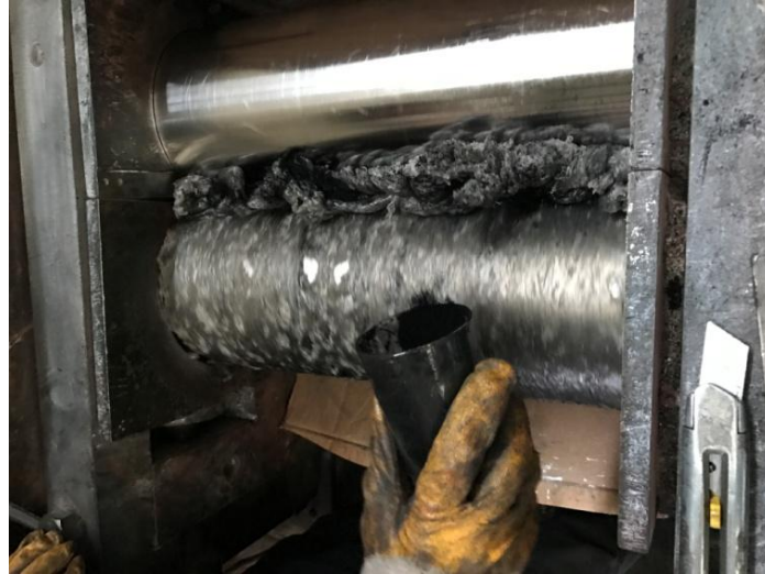
Şekil 7.4. Kloropren kauçuk hamuruna dolgu maddelerinin eklenmesi.
