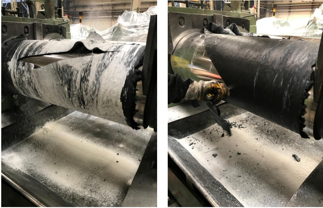
Şekil 7.21. Silika dolgu maddesinin kloropren kauçuk hamuru ile karışımı.
