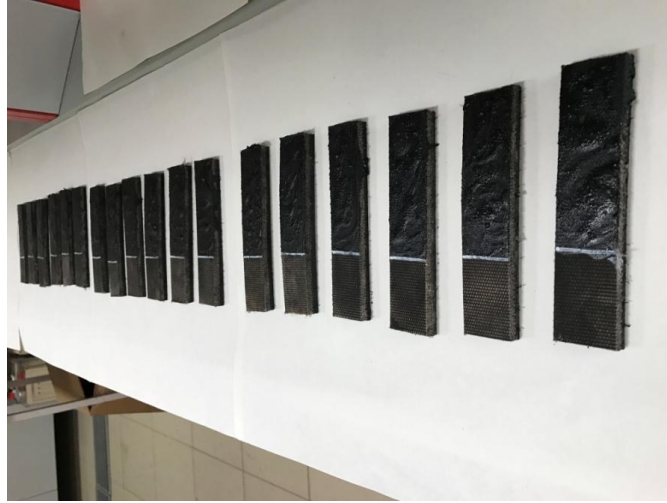
Şekil 7.9. Soğuk vulkanize yapıştırıcı uygulanmış konveyör bant numuneleri.
