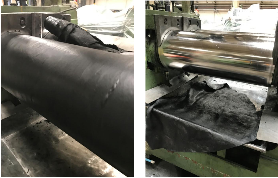
Şekil 7.23. Kloropren kauçuk hamurunun bant haline getirilmesi.
