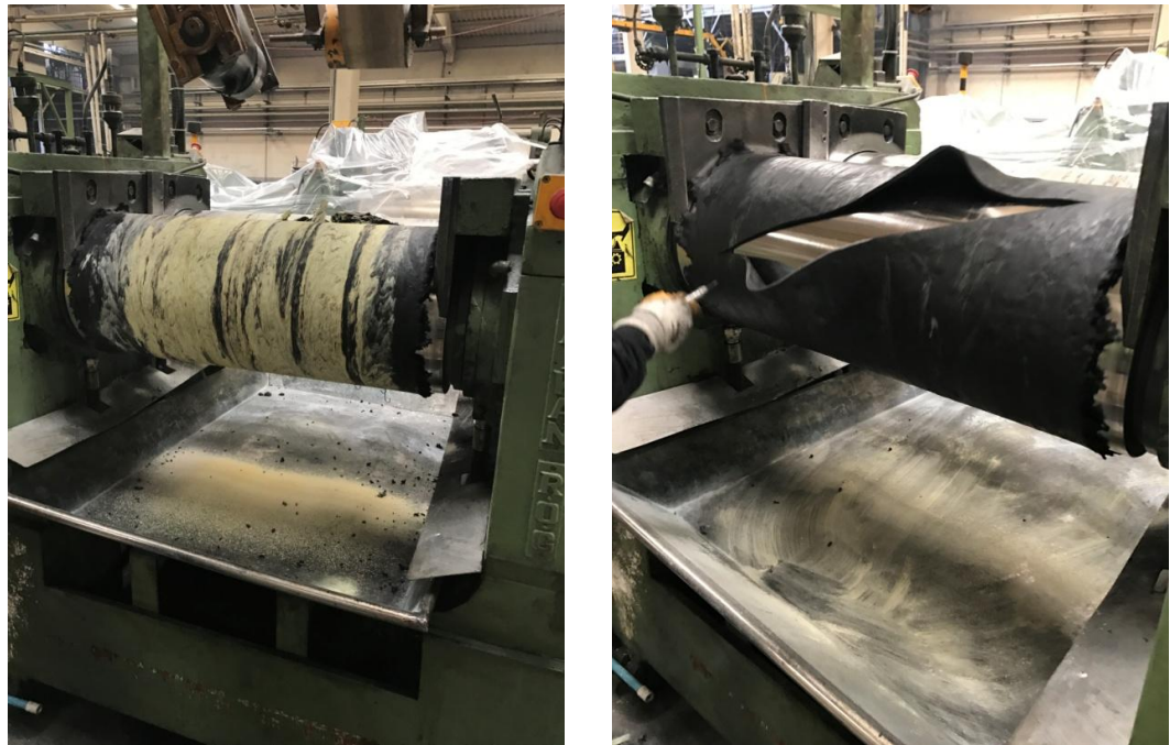
Şekil 7.22. Metal oksitlerin ve hızlandırıcıların kloropren kauçuk hamuru ile karışımı.
