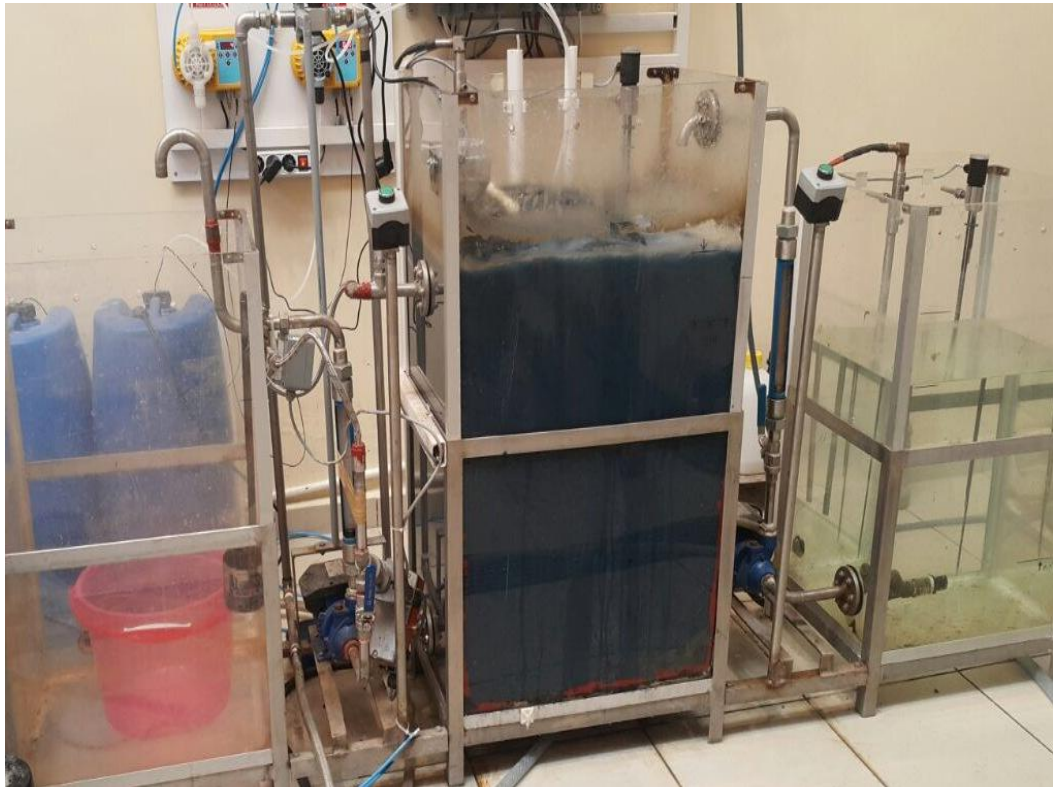
Şekil 9.1. Sisteme ilk yüklenen sentetik tekstil atıksuyu ile MBR sisteminin görünümü (Dimozol Blue BRF %150).
