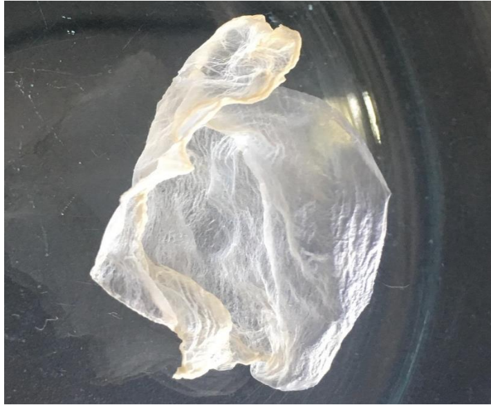
Şekil 5. 8. 80°C'de kurutulmuş Komagataeibacter intermedius 'un ürettiği saf bakteriyel selülozun (H4) görüntüsü.
