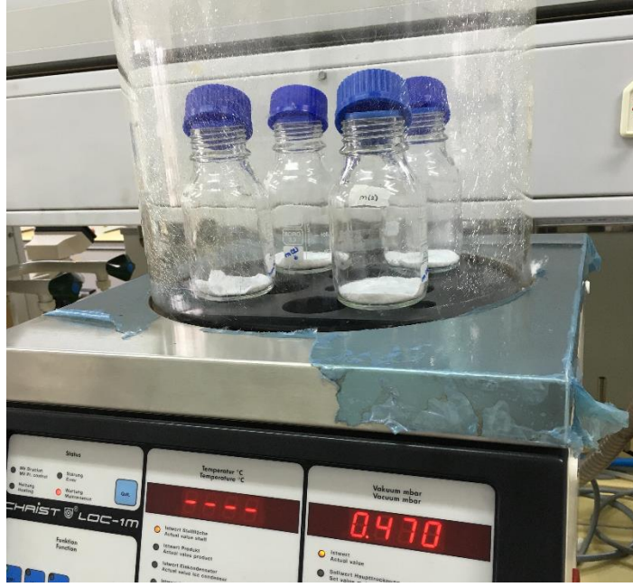
Şekil 5. 7. Saflaştırılmış bakteriyel selüloz örneklerinin (H4, HM3,M2) liyofilizatörde kurutulması.
