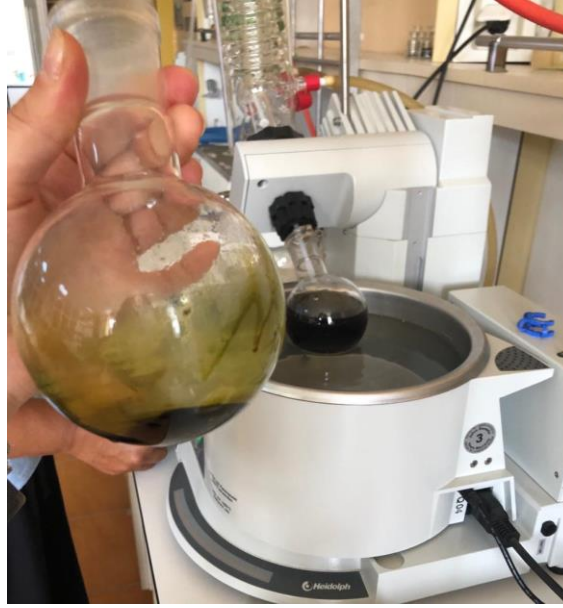
Şekil 3.4. Rotary evaporatör cihazı ile gerçekleştirilen çözücünün buharlaştırılması işleminin görüntüsü
