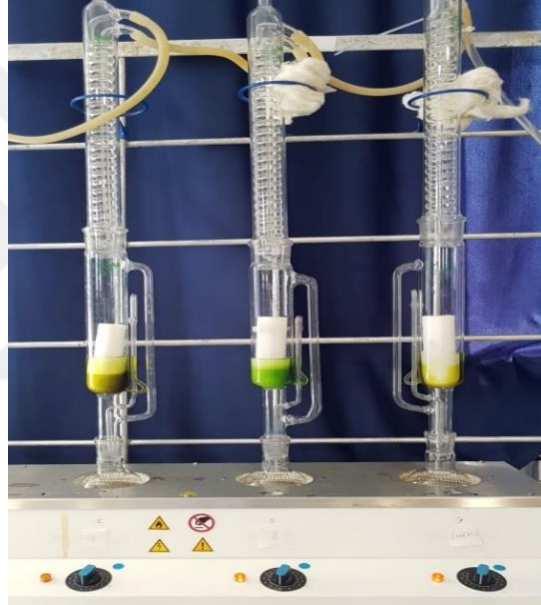
Şekil 3.3. Soxhlet cihazı ile gerçekleştirilen ekstraksiyon işleminin görüntüsü
