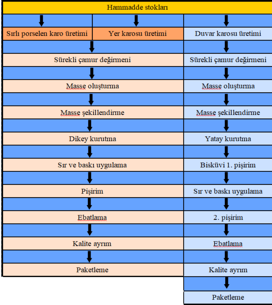
Şekil 2.3. Yer ve duvar karosu üretimine ait iş akışı
