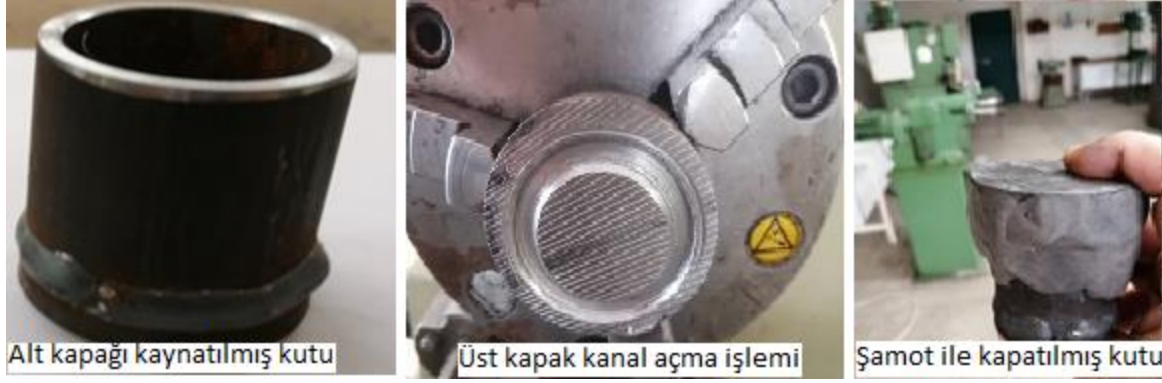
Şekil 3.2. Borlama kutusu hazırlama aşamaları
