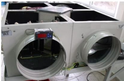
Şekil 4. Deneyde kullandığımız ısı geri kazanım cihazı (Kocabaş, 2014; Kocabaş ve Savaş, 2015).
